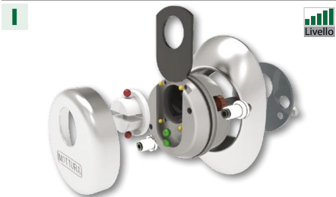
Sfere d'acciaio a protezione del corpo del cilindro e sulla rondella cromata + una piastra al manganese per una protezione totale.
